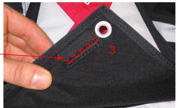
Die innere Stoffschicht der Klappe 3 mit einem scharfen Messer circa 15 mm lang einschneiden. Hier wird das Aktivierungselement des Öffnungsautomaten durchgeführt.
