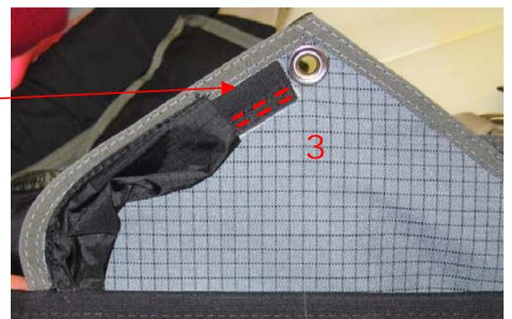
Den selbstklebenden Stoffschlauch an dem Einfassband der Klappe 3 entlang und durch das Loch in der Klappe 1 hindurch, bis in die Kabeltasche des Öffnungsautomaten-Halterung hineinlegen. Anschließend an der linken Kante vernähen. Den Anfang und das Ende der Naht verriegeln. Den Stoffschlauch so dicht wie möglich bis an die Klappe 1 heran festnähen.
