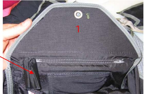
Stoffschlauch mit Öffnungsautomat und durchgeführtem Kabel.
