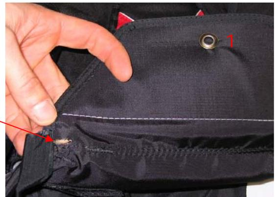
Die elastische Halterung des Aktivierungselementes dicht neben die Edelstahl-Öse mittels Kastennaht aufnähen.
